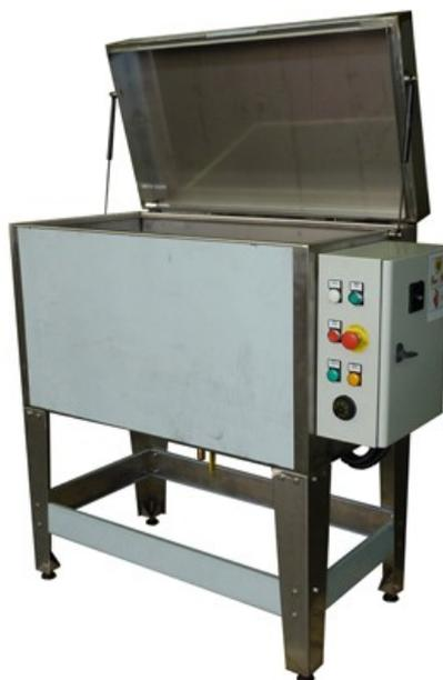
Промывочные ванны для промывки деталей и заготовок вручную полностью изготовлены из нержавеющей стали AISI 304 и предназначены для ручной промывки небольших механических заготовок, мелких деталей или рабочего инструмента. Благодаря обширной поверхности в ваннах можно удобно мыть заготовки средних размеров. Речь идет об экологически безопасных решениях, для которых используются не образующие пены биоразлагаемые моющие средства на основе воды.
