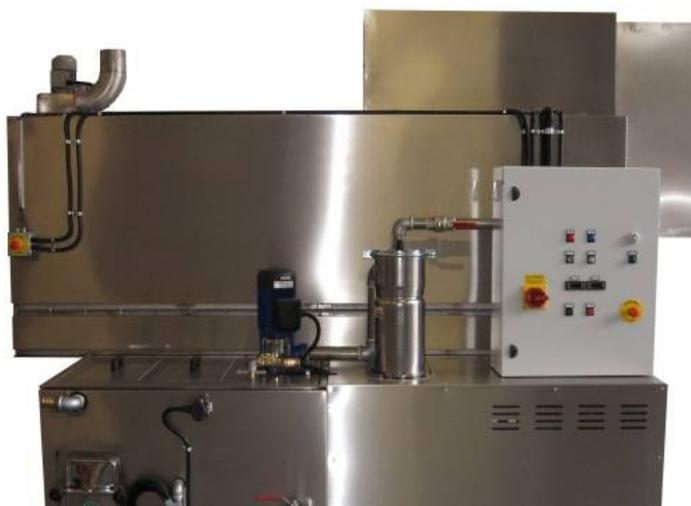
Машины для промывки деталей и заготовок путем погружения в раствор воды и мощного средства при температуре 70°C. Промывочные системы могут быть с одним или несколькими этапами промывки, с функцией сушки или без нее (в зависимости от специальных требований к обработке сырья). Принцип работы: барабан вращается вокруг горизонтальной оси в растворе. Этот тип оборудования отлично подходит для промывки заготовок с внутренними каналами и полостями, глухими отверстиями и для деталей сложной формы.
